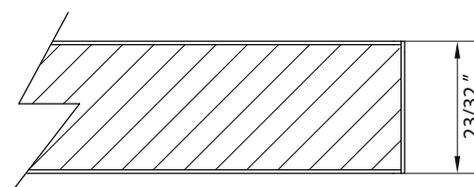
La porte est fabriquée à partir d'un panneau de MDF de 18 mm d'épaisseur recouvert de papier décoratif de chaque côté et par la suite laminé. Un fini brillant est apposé sur le côté façade et un fini mat sur l'endos. Les chants sont recouverts de la bande de chant de votre choix.
