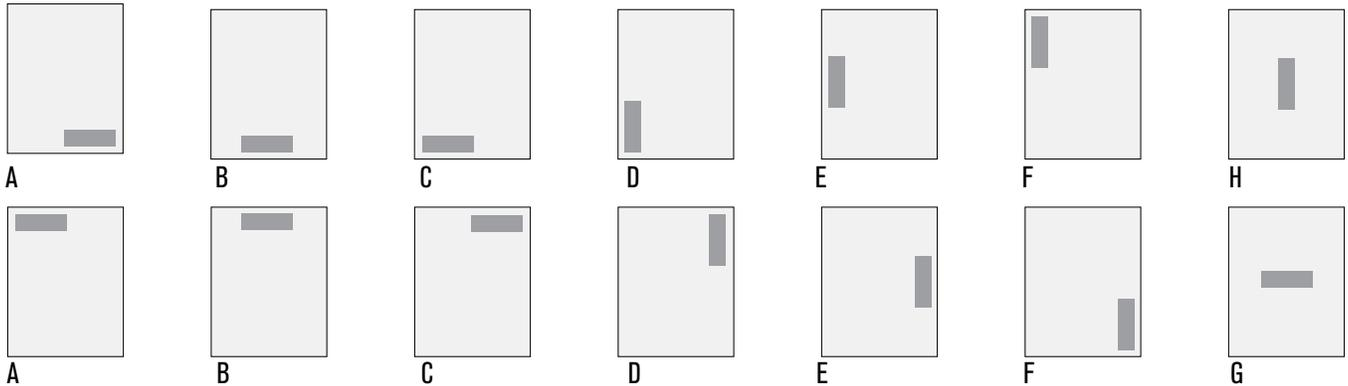
Dans les positions A à F, le côté long de la poignée est placé à 7/8" (22 mm) du bord de la porte.
